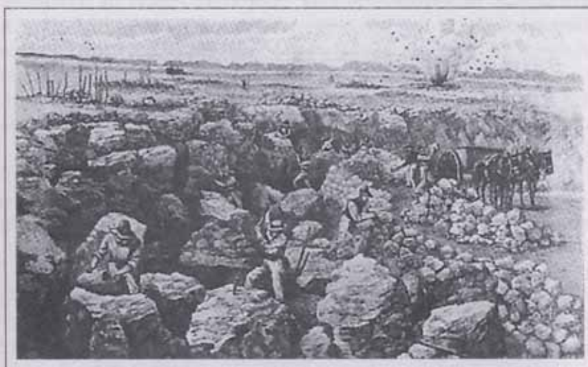
Fig. 23 - Iquique: operai che spezzano il caliche per estrarre il salnitro, poi trasportato su carretti a cavalli (disegno di M. PIERCE, A visit to Chile and the nitrate fields of Tarapacá , Londra, 1880).
