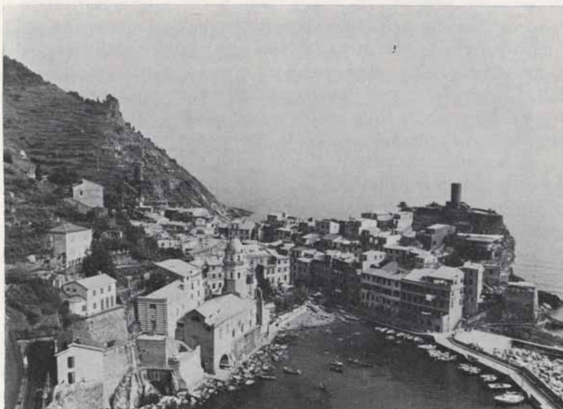
Fig. 4. — Baia di Vernazza. La parte estrema dell'abitato si stende su uno scrimolo roccioso, alla cui sommità si innalza l'antica torre, che delimita la piccola baia. Ad est dell'abitato si intravedono il ciglio e la lizza di una frana in roccia innescatasi nelle arenarie zonate disposte a franapoggio.
